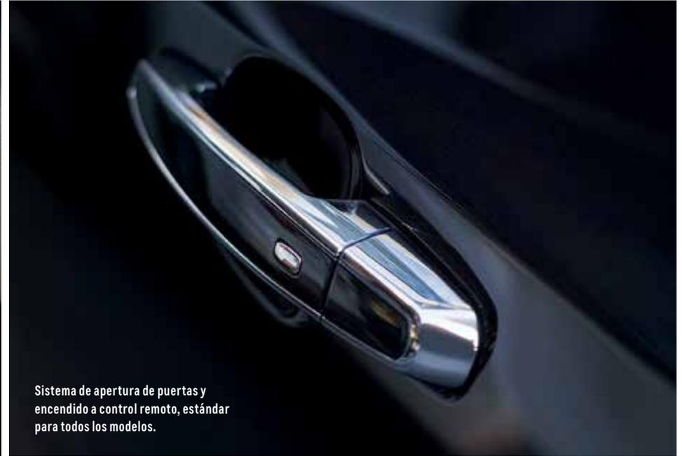
Sistema de apertura de puertas y encendido a control remoto, estándar para todos los modelos.
